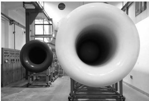
图9 双级(左)、四级(右)低速轴流压气机试验台
